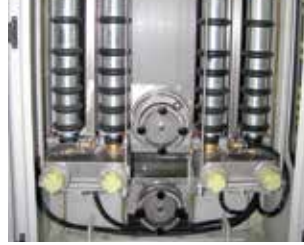
Ayarlanabilir rulolar sayesinde çizilmeleri önleyici özel tasarım Special design to prevent scratches with adjustable roller
