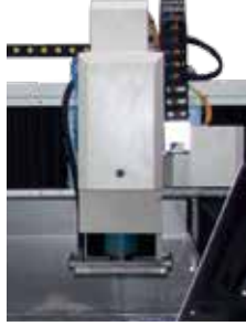
Üç kademeli işleme kafası (Sektör, Rodaj, Keçe) Three stages working head (Segmented, Grinding, Polishing)
