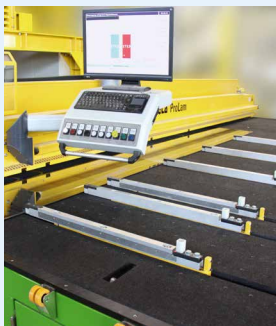
Bedienerfreundlich: Automatische Anschlagbrücke für Z-Schnitte und Einzelschnitte
