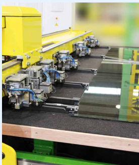
Exakt positioniert: Doppelgreifer zum Schieben und Ziehen der Glasplatten (AdvaLam)
