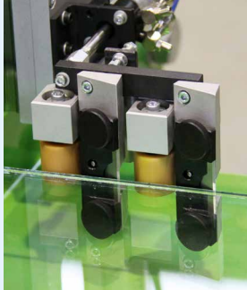
Präziser: Automatische Entfernung des Folienüberstandes
