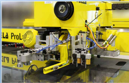
Randentschichtungsbrücke mit Floatglas-Schneidkopf und automatischer Folienabschälvorrichtung
