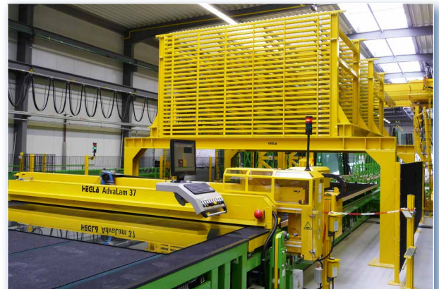
Platzsparende Zwischenspeicherung der Restplatten oberhalb der Schneidanlage
