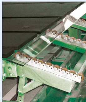
Automatisch: Entsorgung von Randschnitten (AdvaLam)
