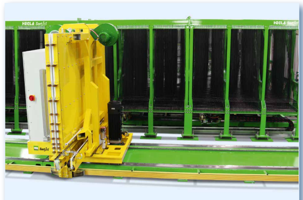
SortJet – Kontinuierlicher Produktionsfluss vom Zuschnitt auf die Isolierglaslinie
