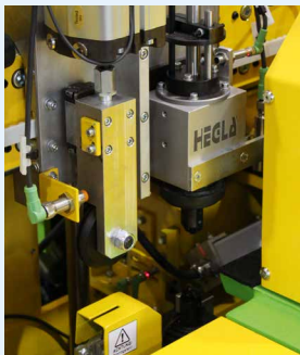
Präzise: Doppelschneidkopf mit Messertrenntechnik
