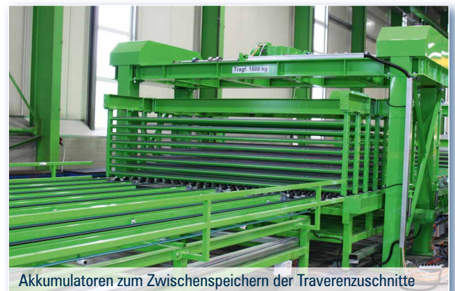
Bedienerloser Traverenzuschnitt auf der HEGLA AdvaLam
