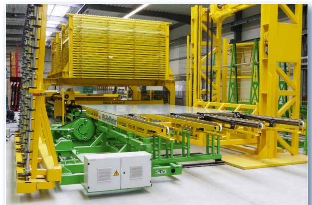
Automatische Prozesse ersetzen manuelles Handling: Hub- und Förderstation des ReMasters
