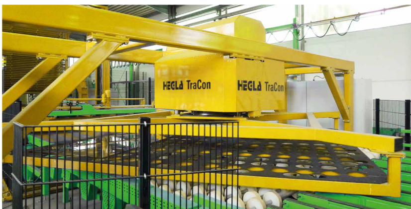
Automatisches X/Y-Brechen: Linienlösung mit Traverendrehvorrichtung TraCon und zwei Brechstationen
