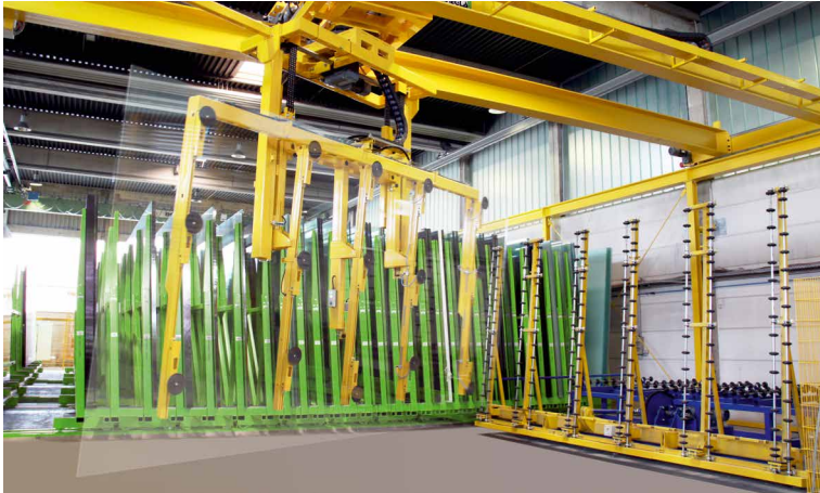
PBD 6133 Die drehbare Portalbeschickung kann von jedem Abstellplatz Glas durchkämmend und frontseitig aufgeben. Sie ist als Voll-, Halb- oder als Brückenportal erhältlich.
