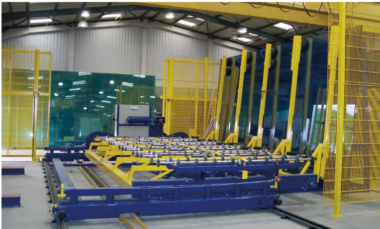
BBF 6133 Mit der stationären oder verfahrbaren HEGLA Flurbschickung (EBS/BBS) kann das Glas direkt vom Lagergestell abgenommen werden. In der verfahrbaren Variante (EBF/BBF) kann sie bis zu 6x2 Abnahmepositionen realisieren.
