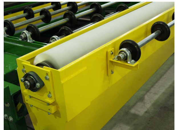
Bürstenwalze mit Auffangbehälter zur Lucite-Entfernung von der Glasunterseite, optional mit Absaugung.
