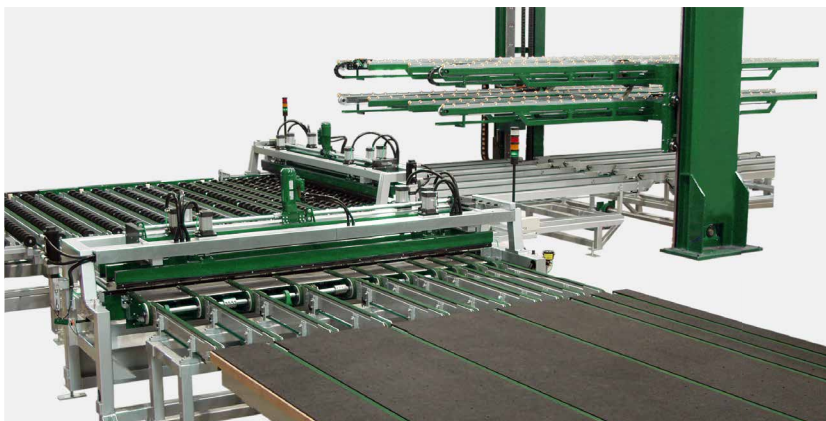
Automatisches X/Y-Brechen: Linienlösung mit Eckübergabe und zwei Brechstationen
