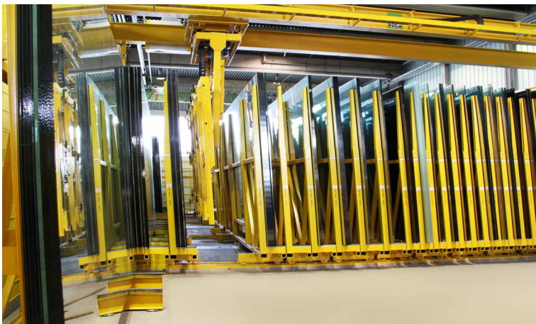
KPL-A Das automatische Compact Storage KPL-A Plus ermöglicht in Kombination mit einer Portalbeschickung oder einem Compact Loader zusätzliche Abstellplätze im automatischen Zugriff.
